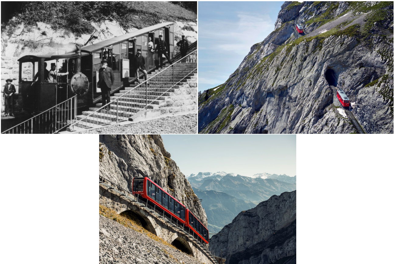
Drei Zahnradbahn-Generationen auf einen Blick: Dampftriebwagen aus dem Jahr 1889, elektrischer Triebwagen aus den 1930er-Jahren (oben) und neue Panoramawagen in Doppeltraktion (unten), © Pilatus-Bahnen AG
